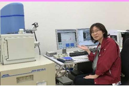
②走査電子顕微鏡+X線元素分析装置
